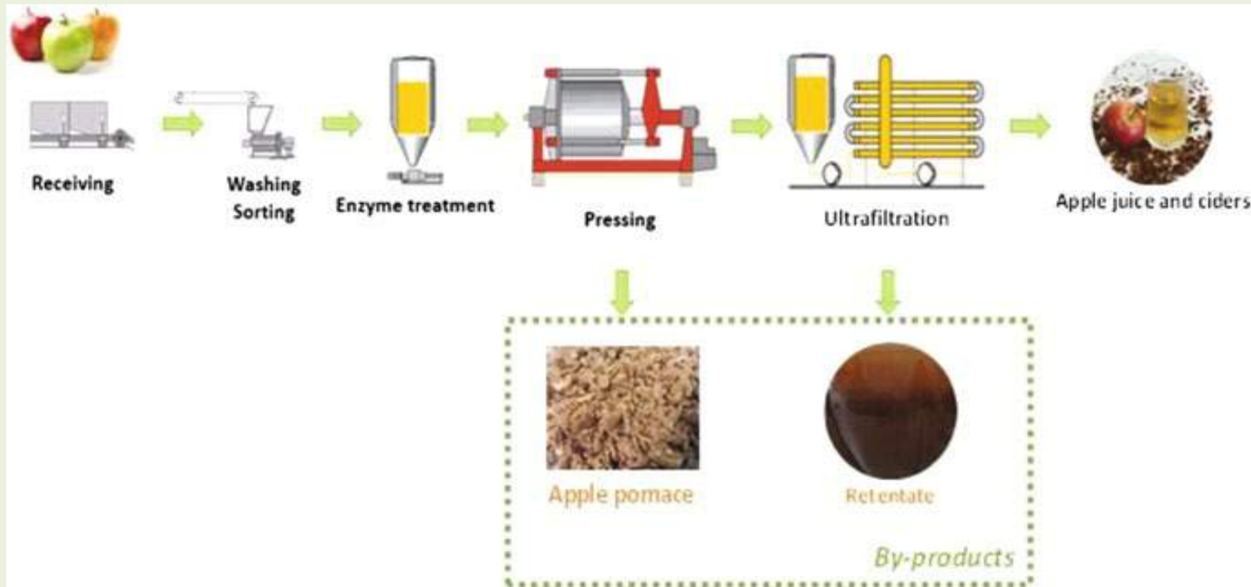
Representación esquemática de los pasos de extracción y procesamiento del zumo de manzana y sus principales subproductos, Fernandez et al., 2024
